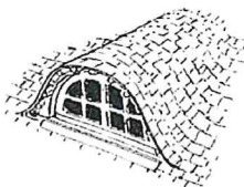
lucarne à jouées galbées (couverture ardoise ou chaume)
