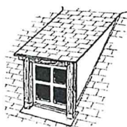
lucarne rampante ou en chien couché
